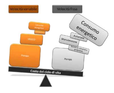
VASCO consiste in compatte unità che, collegate a qualsiasi pompa in commercio, ne gestiscono il funzionamento per mantenere costante una determinata grandezza fisica (pressione, portata o temperatura del fluido o altro ancora) al variare delle condizioni d' utilizzo. In tal modo la pompa è azionata solo quanto e quando serve evitando inutili sprechi energetici ed allungandone la vita.
