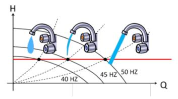
Negli impianti idrici dotati di VASCO l' autoclave viene sostituita da un piccolo vaso d' espansione con l' unica funzione di compensare le perdite (o i minimi consumi idrici) e mantenere la pressione quando la pompa viene arrestata.
